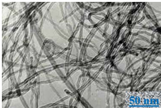
شکل ۱ تصویر TEM نانوذرات نانولوله کربنی چند جداره
