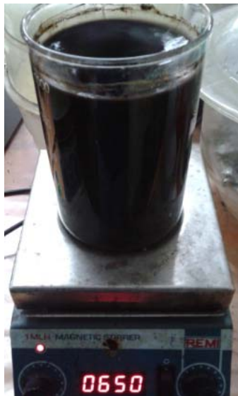
شکل ۳ نانوسیال در طی فرآیند تولید
