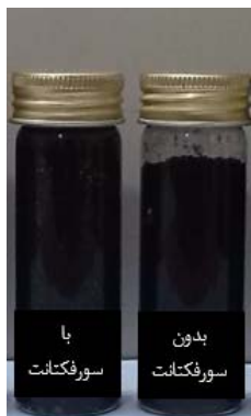
شکل ۲ تصویر پایداری نانوسیال با استفاده از سورفکتانت و بدون استفاده از سورفکتانت
