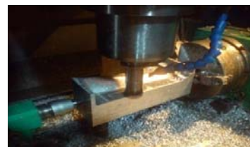
شکل ۱ نمونه مورد نظر در مرحله خشن کاری
