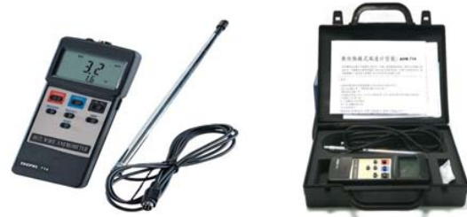
شکل ۵ سیستم بادسنجی سیم داغ (HWA)
