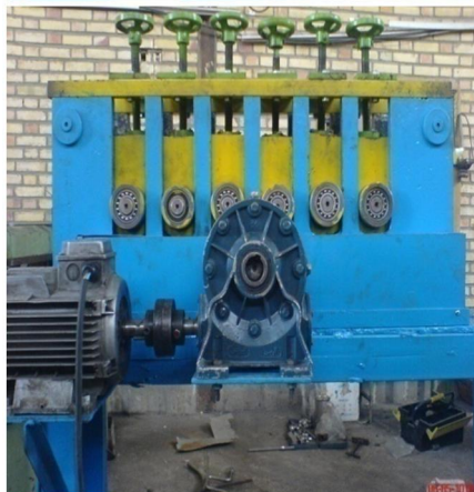
شکل 7 سیستم محرکه دستگاه صاف کن میله های برنجی اکستروژن شده
