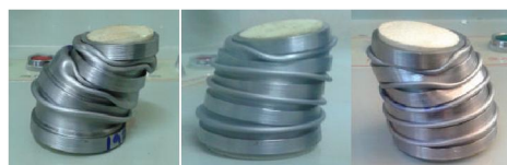
شکل ۶ نمونه های تست شده با فوم و تحت بارگذاری 10^\circ درجه (الف) ۳ شیار ، (ب) ۴ شیار (پ) ۵ شیار
